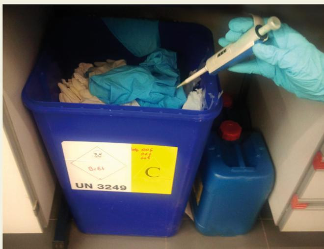
Contenedor de laboratorio para el material contaminado con bromuro de etidio
