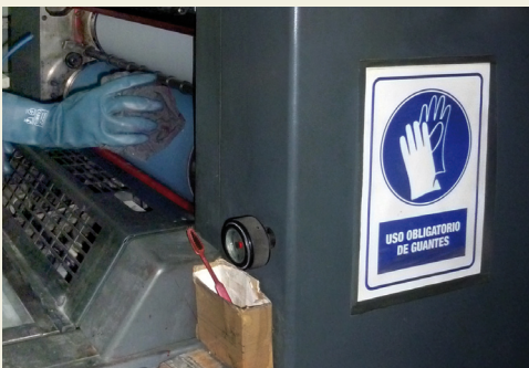
Limpieza manual de rodillos no desmontables de máquina offset
