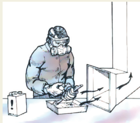
figura 2: Limpieza manual con sistema de extracción localizada
