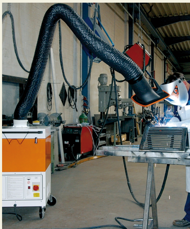
Equipo móvil de ventilación
