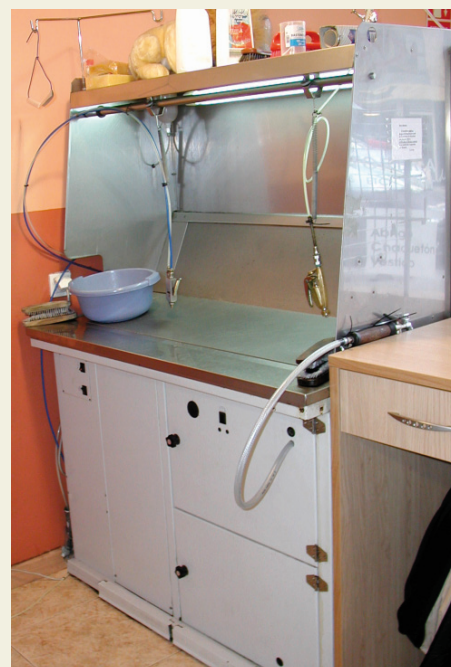
Cabina de desmanchado dotada de extracción localizada
