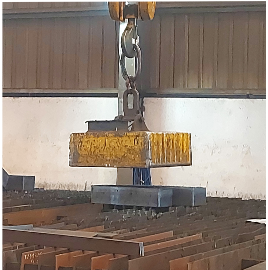
Figura 2: Electroimán de elevación
