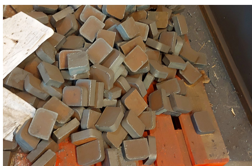
Figura 3: Tipo de piezas que fueron lanzadas hacia el electroimán por la persona trabajadora accidentada
