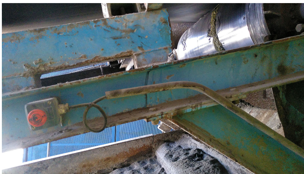
Figura 4: Botón de parada de emergencia tipo seta
