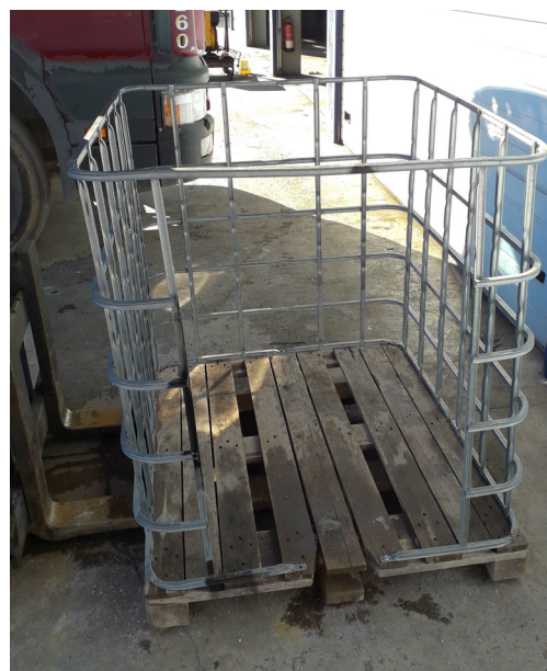
Figura 3: Cesta de fabricación casera, conformada a partir de la estructura del depósito. Cesta apoyada sobre las horquillas de la carretilla por el lado más largo del palé. Lateral de la cesta abierto
