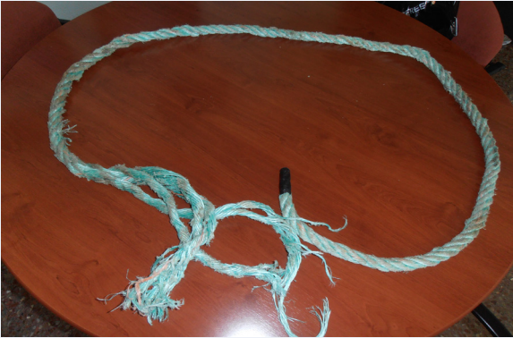
Figuras 2 y 3: Detalles del cabo de retenida y de la zona donde se rompió
