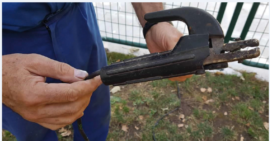
figura 2: estado de la pinza porta-electrodos
