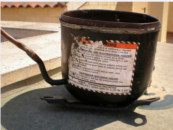
vista cuerpo del compresor
