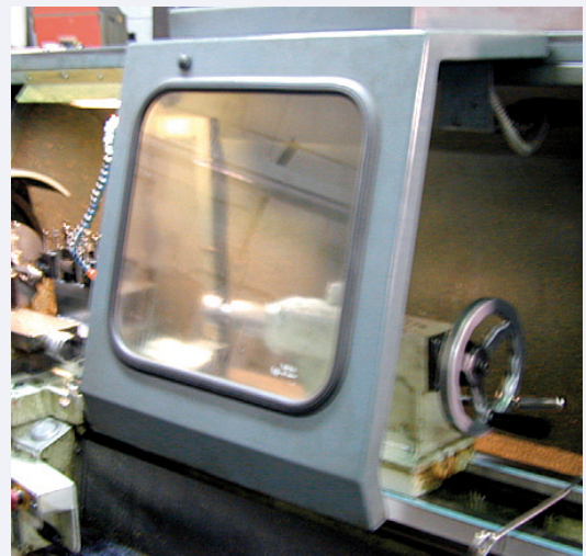
Ejemplo de resguardo con enclavamiento para el punto de operación del torno
