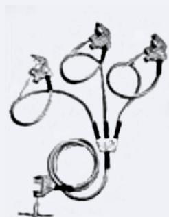
*En la imagen vemos los cables de puesta a tierra utilizados*
