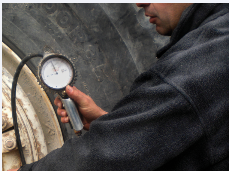
manómetro utilizado, obsérvese la escasa longitud del manguito
