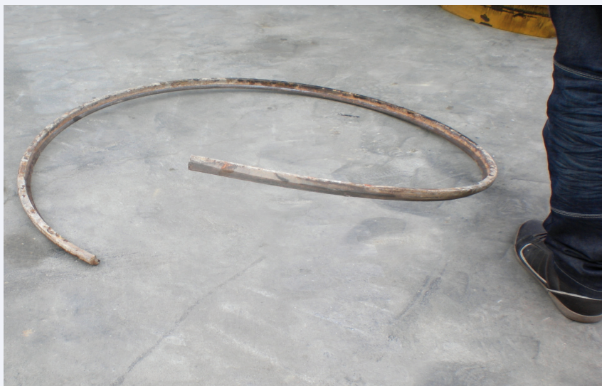
aro de cierre deformado al salir despedido
