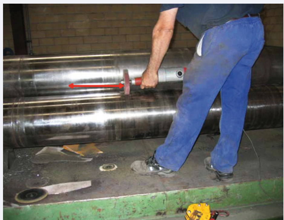
Operación de limpieza-lijado
