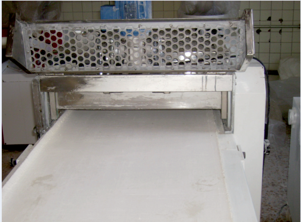
Figura 1. Cuchilla y resguardo levantado
