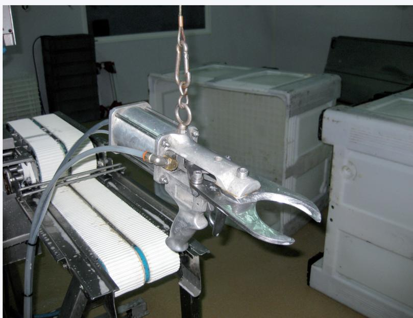
su mano izquierda y procede a pasar el hierro de afilar sobre el corte de las cuchillas con su mano derecha. En un momento determinado actúa involuntariamente sobre el gatillo de accionamiento, a pesar de estar protegido, la cizalla cierra sus cuchillas y corta un dedo de la mano derecha del operario.
