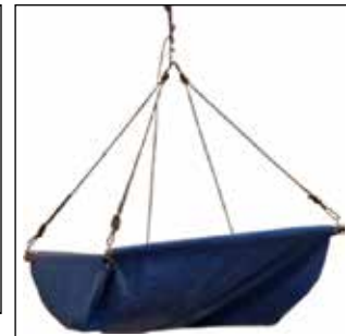
Figura 11. Bastidor de recogida de materiales.
