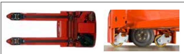
Figura 8. Detalle de distintas configuraciones de las ruedas de tracción y estabilizadoras (4 y 3 + 2 estabilizadoras).
