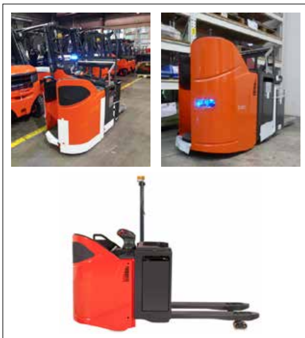
Figura 10. Señales luminosas instaladas en transpaletas eléctricas.
