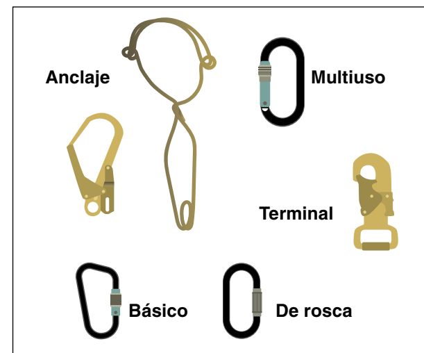
Figura 4. Tipos de conectores (A-anclaje, B-básico, Q-de rosca, T-terminal y M-multiuso).
