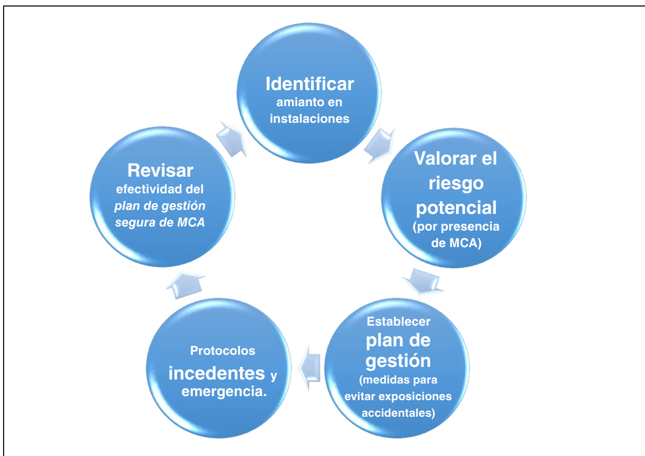
Figura 2. Ciclo de gestión segura de materiales con amianto (MCA) para evitar riesgo por exposición accidental derivado de su presencia
