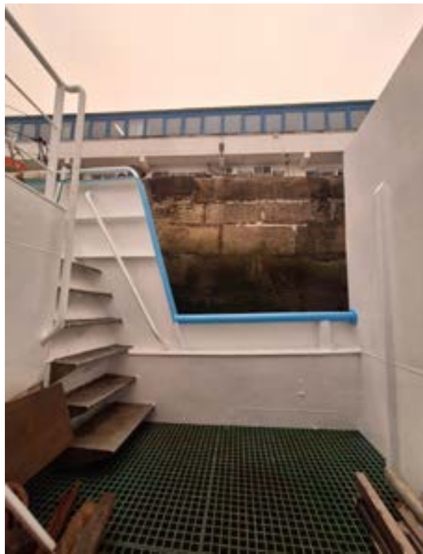
Figura 3. Protección perimetral en un pesquero de palangre de superficie.
