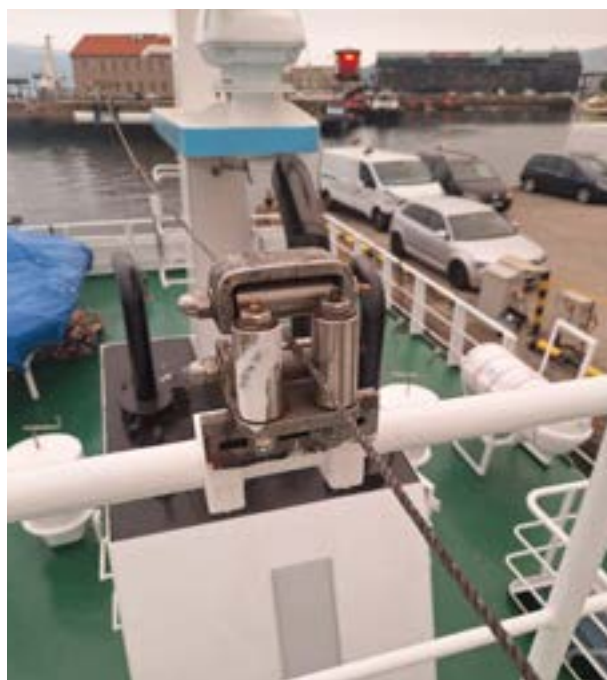
Figura 2. Sistema de guiado frente al riesgo de golpe por rotura de elemento en tensión.
