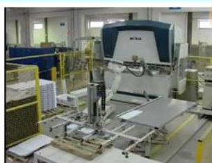
Célula de plegado robotizada
