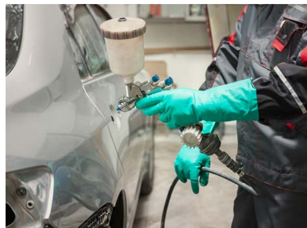
Figura 3. Situación con alta probabilidad de carga por exposición del EPI a nieblas de aerosol.
