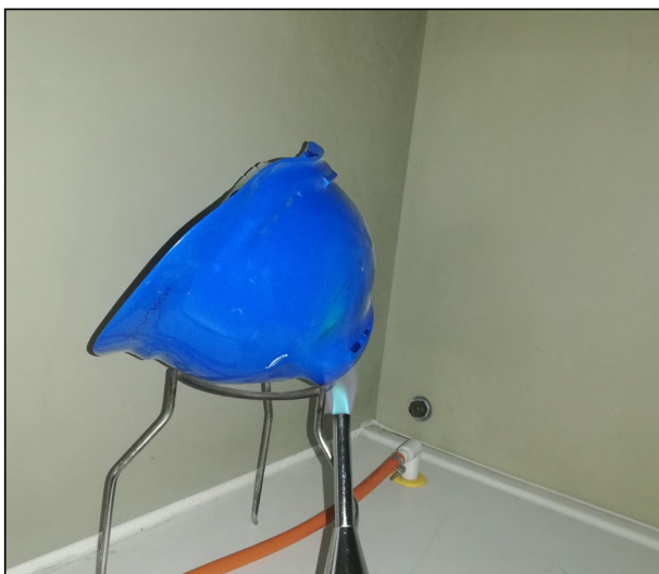
Figura 4. Ejemplo de ensayo de resistencia a la llama.
