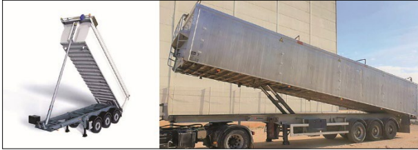
Figura 1. Semirremolques basculantes con cilindro hidráulico en el frente del vehículo y con cilindros entre los largueros del bastidor.
