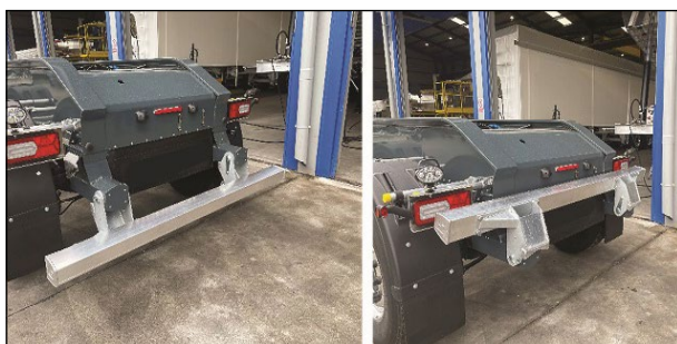
Figura 14. Sistema anti-empotramiento neumático desplegado y recogido.
