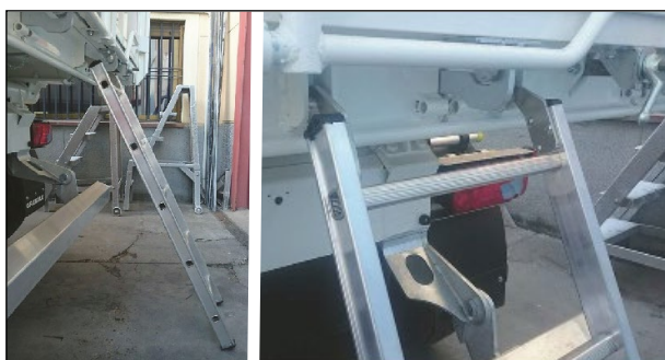
Figura 13. Escalera de mando con ganchos en su parte superior para su fijación segura y detalle de los huecos practicados en la caja.
