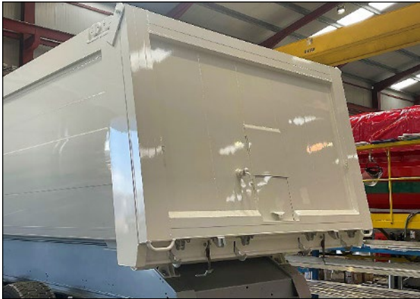
Figura 3. Portón pendular u oscilante
