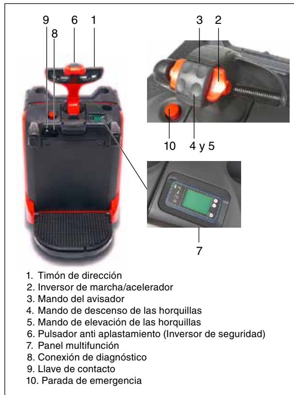
Figura 11. Órganos de accionamiento y de seguridad.
