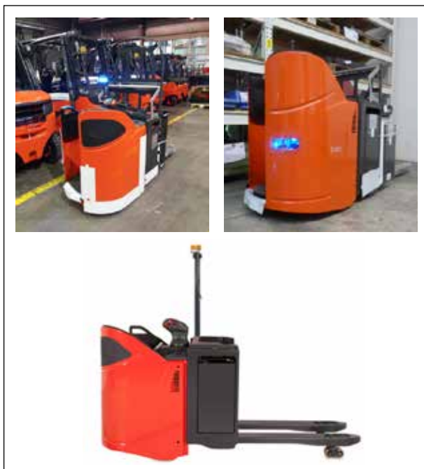
Figura 10. Señales luminosas instaladas en transpaletas eléctricas.
