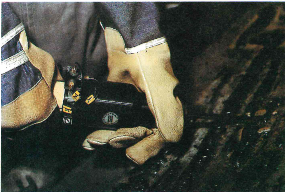
Figura 5.4: Martillo burilador con vibración reducida para preparación de juntas para soldadura.
