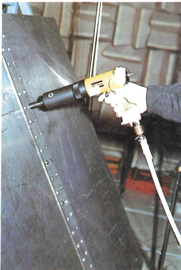
Figura 5.2: Martillo remachador neumático con bajo nivel de vibración.
