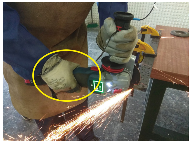
Figura 6. Posicionamiento acelerómetro durante la tarea de corte.
