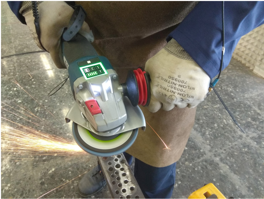
Figura 3. Posición de la herramienta durante las tareas de lijado y desbastado.
