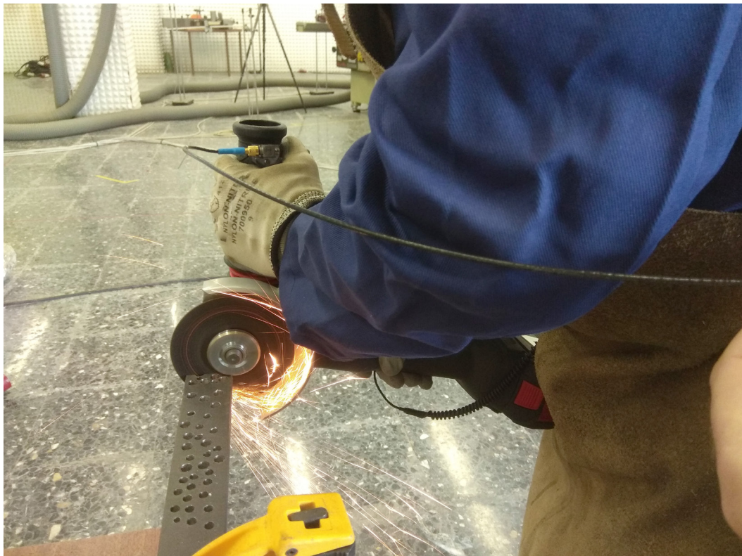
Figura 4. Posición de la herramienta durante la tarea de corte.
