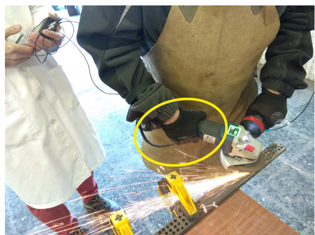
Figura 6. Posicionamiento acelerómetro durante la tarea de corte.
