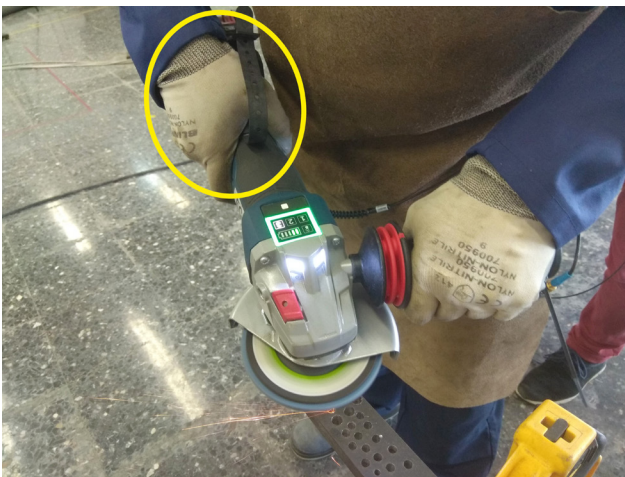
Figura 5. Posicionamiento acelerómetro durante las tareas de lijado y desbastado.
