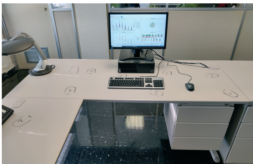
■ Figura 6 ■ Ubicación y disposición del iluminancímetro y de los cabezales (sensores)
