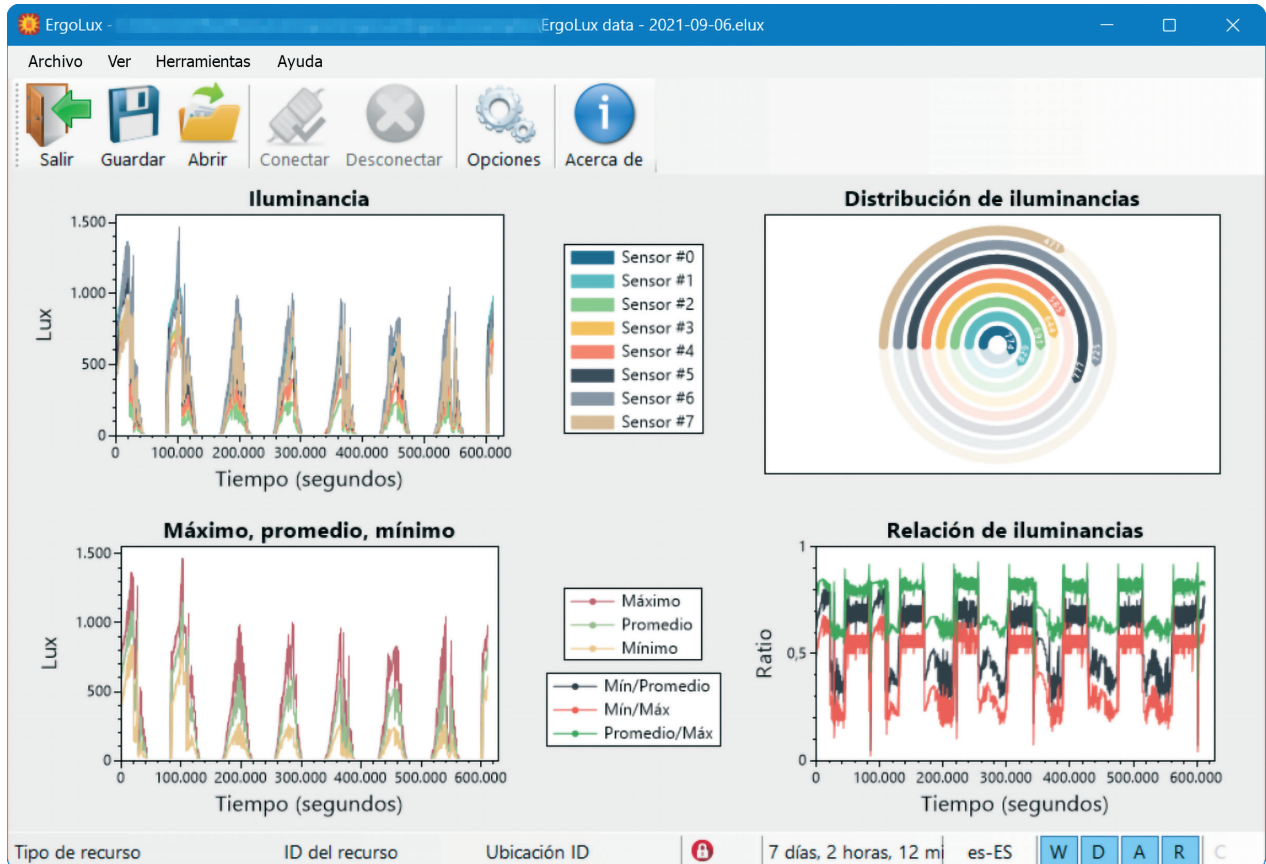
■ Figura 7 ■ Programa informático para la lectura y el registro en tiempo real de los valores de iluminancia
