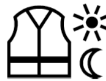
Tipo AB2 o AB3 Equipo para uso con luz diurna y en la oscuridad
