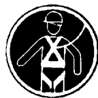
Protección individual obligatoria contra caídas
