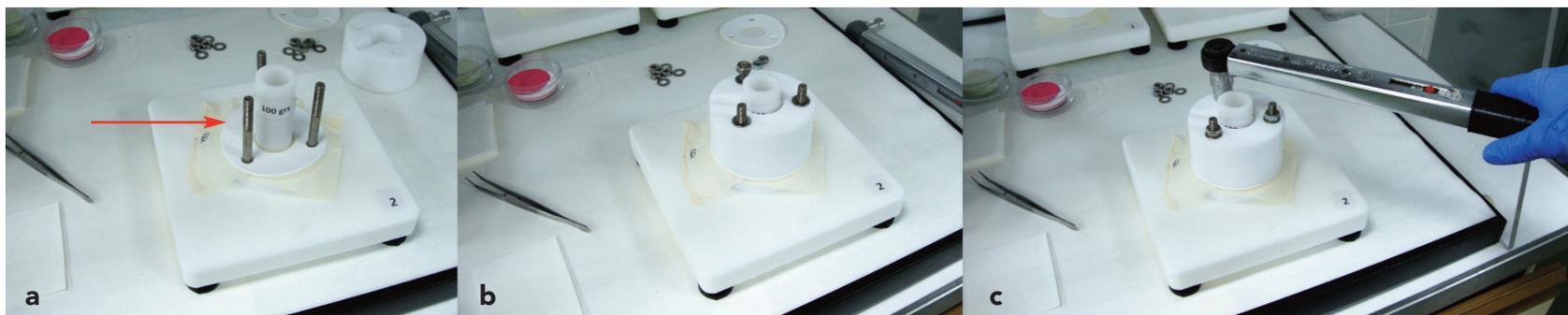
**Figura 4.8** Montaje de la celda de ensayo
