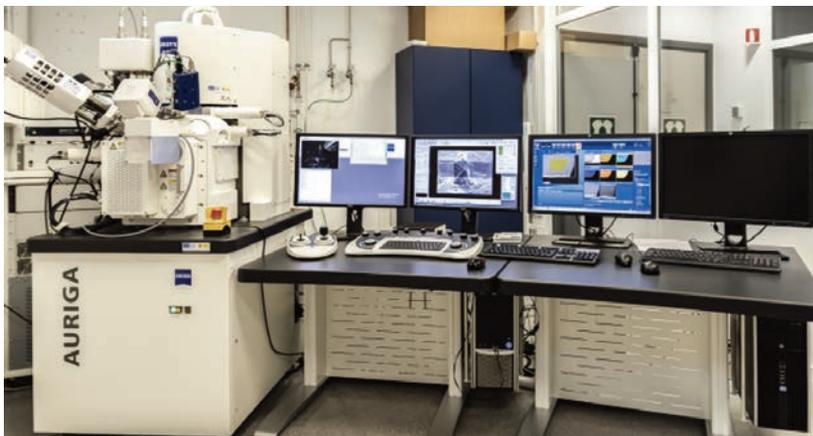
**Figura 4.11** Microscopio Electrónico Dual BEAM (FIB-SEM) ZEISS AURIGA.
