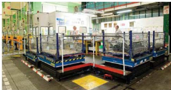
Nuevas mesas elevadoras de la línea de Embutición.
