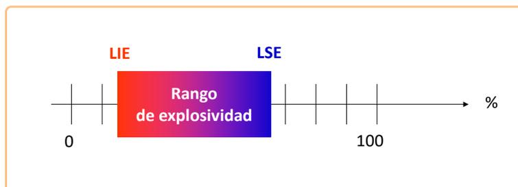
3. Una energía de activación, **fuerza de ignición** o fuente de inflamación. Para que se inicie una explosión se necesita una **energía mínima de ignición** o de activación (EMI) que sea capaz de provocar la inflamación y que la combustión se propague a la mezcla no quemada.
