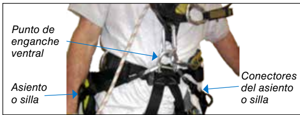
Figura 1. Anclaje al arnés de un asiento manufacturado.
