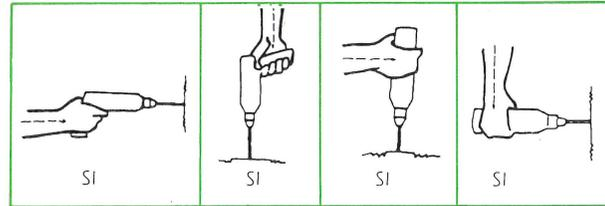
\* Buen diseño de las herramientas, utensilios y del puesto de trabajo, para conseguir una buena adaptación al trabajador. De esta forma se obtiene la relajación de la mano y de la muñeca.
