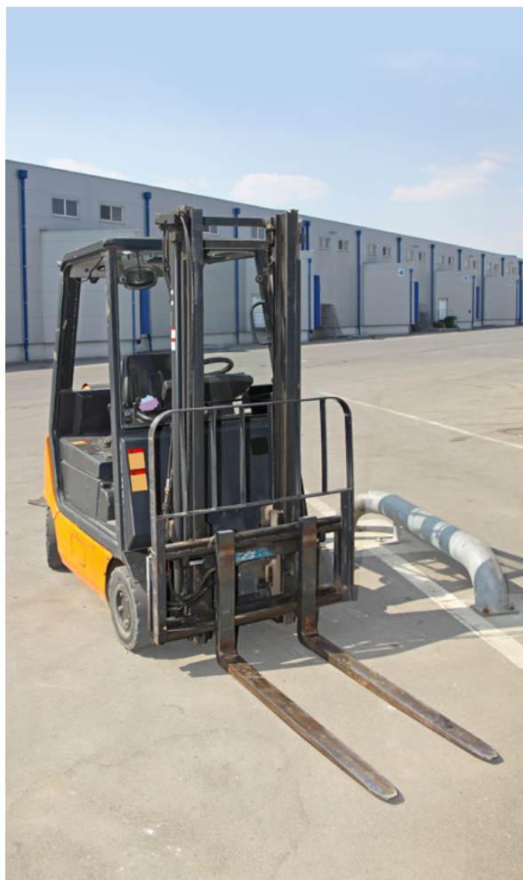
Carretilla elevadora con elementos frontales de seguridad.
