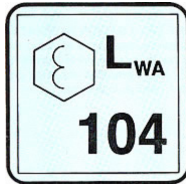
Figura 1 Ejemplo de placa indicadora de potencia acústica ( L_{WA} ) que debe figurar en la maquinaria incluida en el R.D. 245/1989
