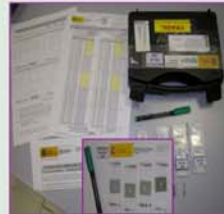
Muestra "RELOK", cubreobjetos especial delimita campo de recuento (CF). Reticula Walton-Beckett (CF: 100 µm diámetro) superpuesta.
