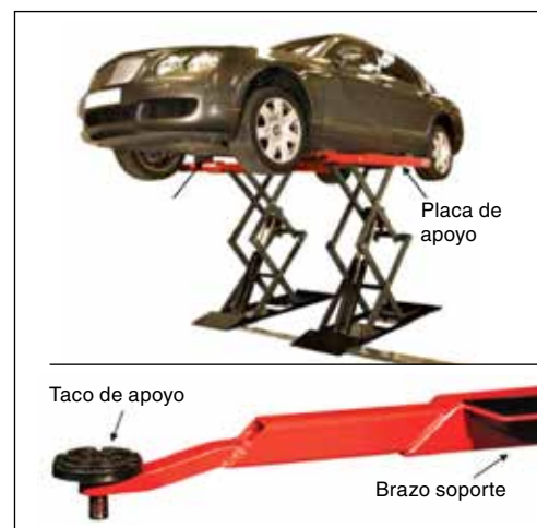
Figura 1. Dispositivo soporte de la carga por el chasis con rueda libre
