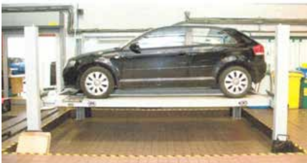
Figura 5. Espacio libre hasta la zona de apoyo de las columnas
