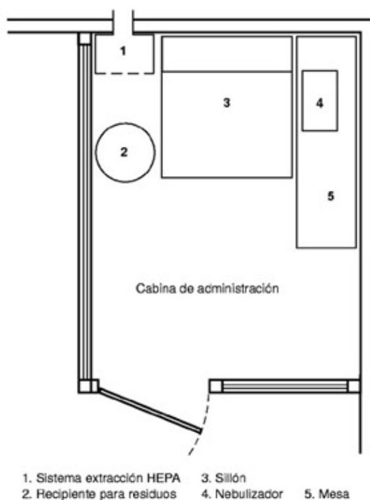
Figura 1. Diseño de cabina específica para la administración de pentamidina en forma de aerosol
