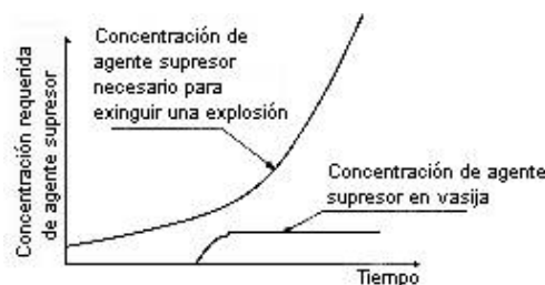
Fig. 6: Concentración de agente supresor durante una supresión fallida (Insuficiente agente supresor)
