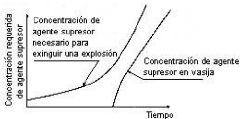
Fig. 5: Concentración de agente supresor en el transcurso de una supresión fallida (Explosión detectada demasiado tarde)
