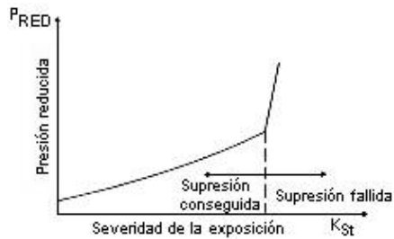
Fig. 1: Variación de la severidad de explosión ( K_s ) con la presión reducida en una explosión suprimida
