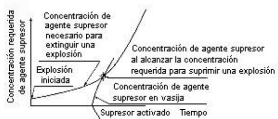
Fig. 4: Comparación de la concentración requerida de agente supresor, con la aplicada en el curso de una supresión eficaz
