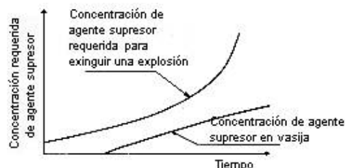
Fig. 6: Concentración de agente supresor durante una supresión fallida (Agente supresor inyectado demasiado lento)
