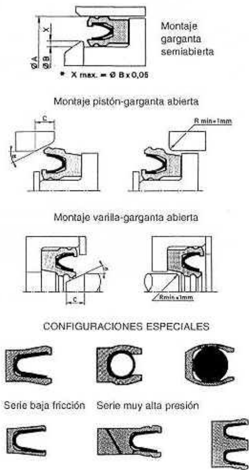
Fig. 6: Juntas para varillas, pistones y árboles rotativos
