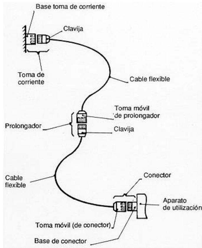
**Fig. 4: Esquema indicando el empleo de los accesorios**
