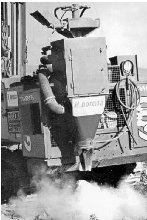
Fig. 7: Conjunto de cámara de expansión y sistema de filtrado
