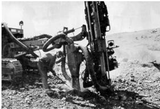
Fig. 6: Conducto flexible adaptable a la movilidad del equipo
