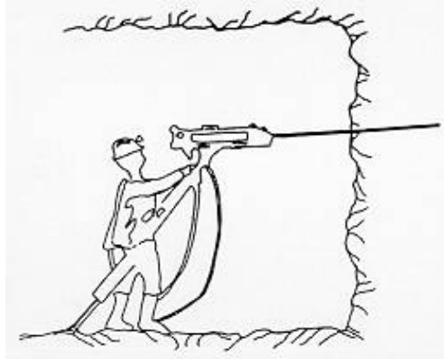
Fig. 1: Perforadora manual con sistema de inyección de agua
