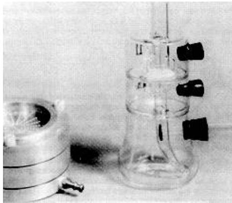
**Fig. 1: Recogida en medio acuoso. Muestreador May**
