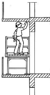
Fig. 9: Andamio situado en voladizo
