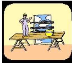
Fig. 16: Andamio situado junto abertura en pared protegida
