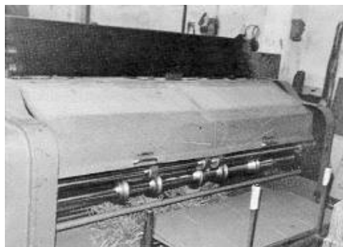
Fig. 6: Salida de material y dispositivo de acopio a pie de máquina. Órganos de corte protegidos
