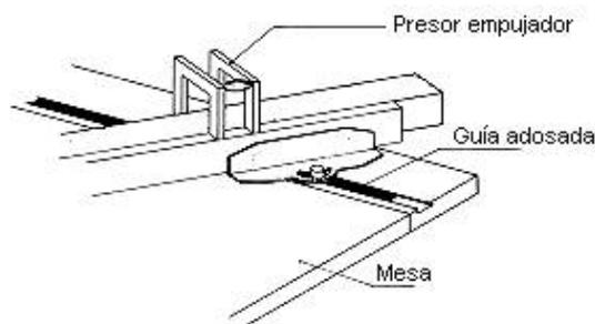
La regla graduada se desliza sobre un carril adosado al tablero y dotado de toques que eviten su salida; consta de un transportador de ángulos, manijas, prensos y las correspondientes piezas de fijación.
