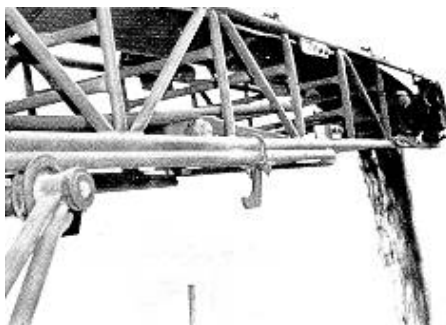
Pletina de tope para mantener en posición una cinta de altura regulable
