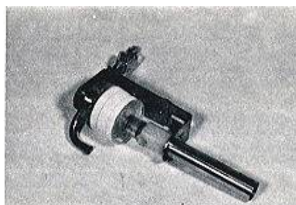
Fig. 3: Unidad de captación cassette-ciclón
