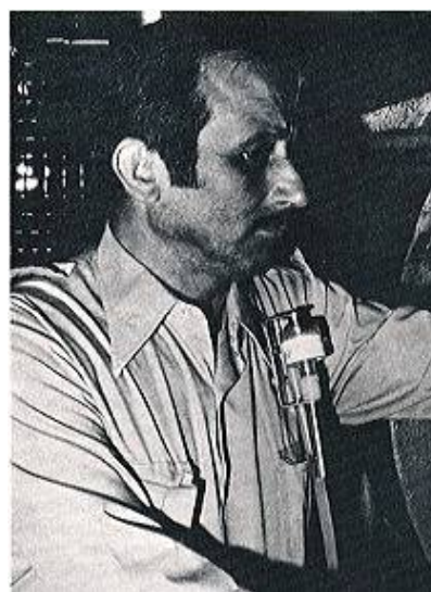
Fig. 6: Toma de muestra con cassette ciclón
