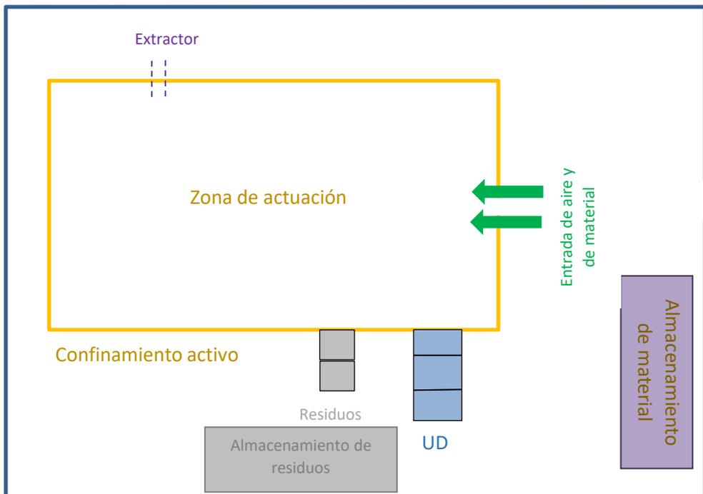
Un técnico de prevención con la especialidad de higiene industrial está elaborando el plan de trabajo de un **desamiantado de una sala de calderas**. Se plantea realizar un **confinamiento activo** como el mostrado en la figura.
