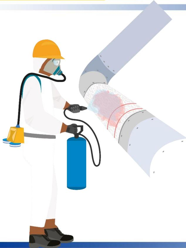
Una empresa de desamiantado va a realizar por primera vez un trabajo de retirada de un **calorifugado desmontando con humidificación y aspiración.**
